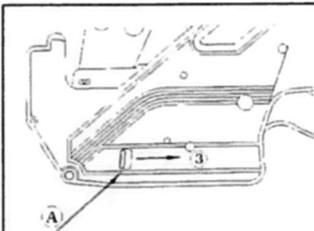
Ziehen Sie Hebel [A] nach hinten [3] und öffnen damit die Bodenplatte
