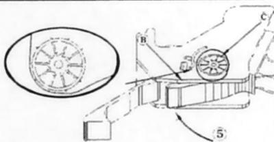
Schließen Sie die Klappe [5]. Ziehen Sie den Etikettenstreifen [B] nach hinten und legen Sie ihn über das Transportrad [C].
