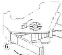
Schließen Sie nun auch die Bodenplatte [6]. Ziehen Sie hierbei den Etikettenstreifen mit dem Daumen leicht nach hinten
