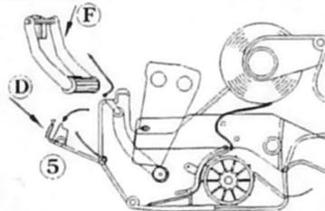
Ersetzen Sie die Farbwalze gegen eine Neue und setzen Sie den Halter in umgekehrter Reihenfolge wieder ins Gerät ein.
