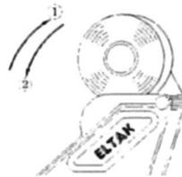
Schwenken Sie den Etikettenhalter nach oben heraus [1], schieben Sie nun die Etiketten durch das Gerät nach unten, schwenken Sie den Halter wieder ein [2] bis er einrastet
